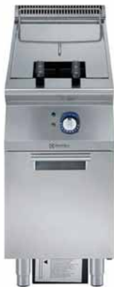
391337 (E9KKGDBAMCA) Fritéza, elektrická, 1x23L, "V" tvar vany s tělesy mimo vanu, 2x koš, 1/2 modul 400mm. Teplotní rozsah 105°-185°C, podestavba uzavřená pravými dvířky
